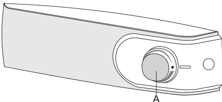
**A Gumb za podešavanje temperature i uključenje/isključenje uređaja**
