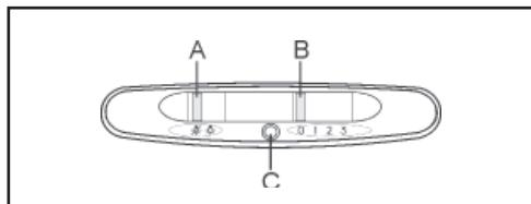
Comutador A: LUZ: posición : luz apagada; posición : luz encendida
