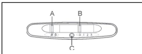
Comutatorul A: LUMINA; poziția : lumina stinsă; poziția : lumina aprinsă
