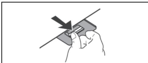
I filtri al carbone attivo non sono lavabili e non possono essere rigenerati, devono essere sostituiti approssimativamente ogni 4 mesi, o più frequentemente secondo l'uso.
