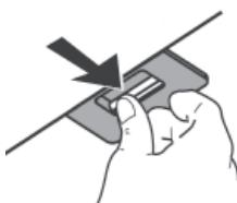
Het actieve koolstoffilter kan niet worden gewassen of gerecycled, en moet ongeveer om de 4 maanden worden vervangen, of vaker bij zeer intensief gebruik.
