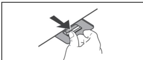
Aktivoitu puuhiiilisuodatin ei sovellu puhdistettavaksi eikä sitä voida uudistaa ja se pitää vaihtaa noin joka 4. käyttökuukausi tai useammin, jos käyttö on erityisen intensiivistä.
