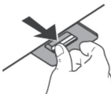
El filtro activo de carbón no se puede limpiar ni renovar y tiene que ser reemplazado aproximadamente cada 4 meses de uso o con mas frecuencia si se lo usa de una forma muy intensa.
