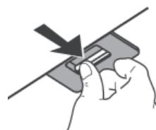
Aktivní filtr z dřevného uhlí není vhodný pro čištění a obnovu a je nutné ho měnit cca. každé 4 měsíce provozu nebo častěji, a v případě zvláště intenzivního používání ještě častěji.
