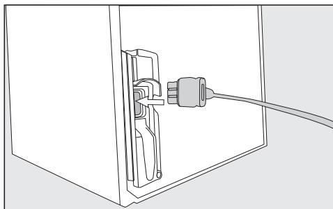
■ Utaknite utikač za uređaj u utičnicu na stražnjoj strani uređaja za hlađenje.
