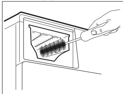
4. Vratite spremnik za deterdžent u vodilice i zatvorite ga. Odradite program ispiranja bez rublja u bubnju.
