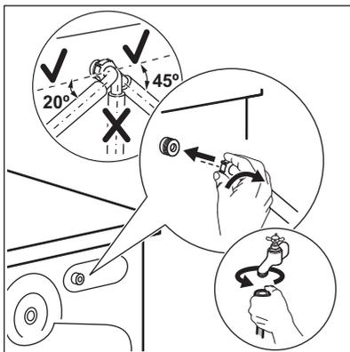
2. Okrenite ga na lijevu ili desnu stranu, ovisno o položaju slavine. Osigurajte da dovodna crijeva nisu u vertikalnom položaju.
