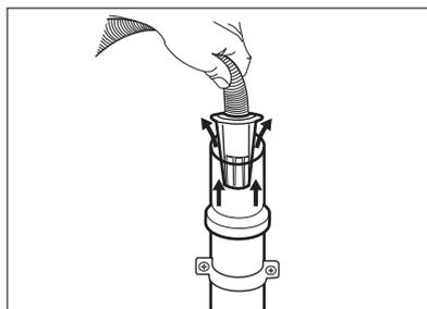
4. Na cijev vertikale s odzračnikom - crijevo za odvod umetnite izravno u cijev za odvod. Pogledajte ilustraciju.
