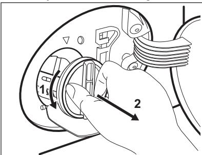
8. Ako je potrebno, uklonite nečistoće i predmete iz udubine filtra.
