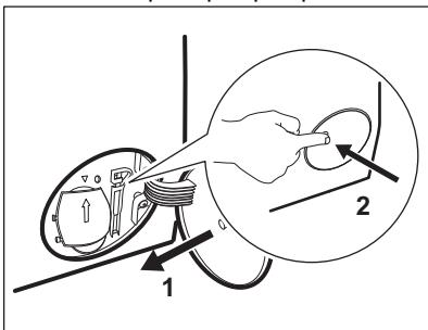
Kada ispuštanje vode primjenom postupka za ispuštanje vode u nuždi, morate ponovo aktivirati sustav za izbacivanje vode:
