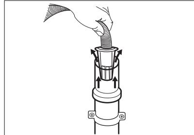
4. Na cijev vertikale s odzračnikom - crijevo za odvod umetnute izravno u cijev za odvod. Pogledajte ilustraciju.
