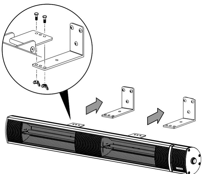
8. Zakrenite uređaj na željeni kut. Uredaj je moguće zakrenuti gore i dolje za  $60^\circ$ . Koristite imbus ključ da biste fiksirali kut.
