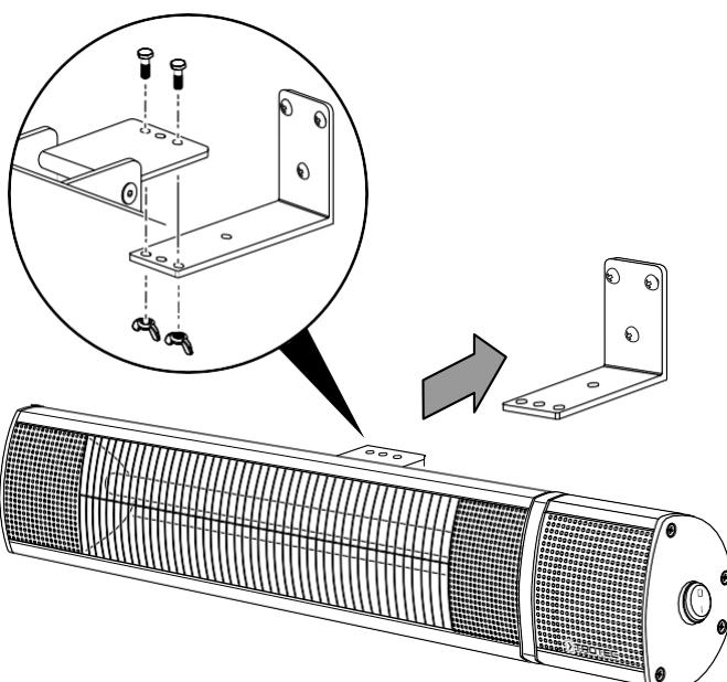
8. Postavite uređaj na željeni kut. Uredaj je moguće zakrenuti prema gore ili dolje za  $90^\circ$ . Koristite imbus ključ da biste fiksirali kut.
