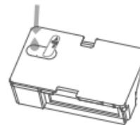
2. Umetnite sklopljeni držač jastučića za brisanje na dno usisivača ravnomjerno u prikazanom smjeru.
