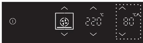
Nakon uključjenja na pokazivaču se pojavi natpis **Prob.** Izaberite željenu temperaturu. Dodirnite tipku START.
