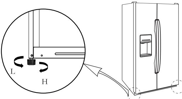
Podesiti lijevu i desnu nožicu kako bi se postigla horizontalnost i stabilnost aparata.
