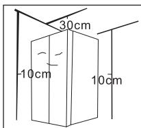
Od gornje površine aparata mora biti više od 30cm prostora. Stranice aparata (bočne i stražnja) moraju biti udaljene više od 10 cm do zidova. To je vrlo važno jer se mora osigurati dobro odvođenje topline prilikom rada aparata.
