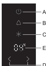
U slučaju previsoke temperature u uređaju, uključi se zvučni signal (**isprekidan zvuk**) i bljeska tipka **B**.
