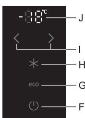
**Isključenje uređaja:** Uređaj isključite dužim pritiskom (3 sekunde) tipke **F** (pažnja: uređaj je još uvijek pod električnim naponom).
