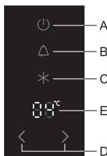
**Uključenje uređaja:** Uređaj uključite kratkim pritiskom tipke **A**.
