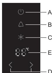
Ovu funkciju koristite kad želite spriječiti nehotično upravljanje uređajem. Postavku uključite 3 sekunde dugim pritiskom na tipku **B**. Na pokazivaču **E** prikaže se slovo **LL**. Time ste zaključali sve tipke osim tipke **B**. Sigurnosnu zaštitnu blokadu isključite ponovnim pritiskom tipke **B**, dugim 3 sekunde.
