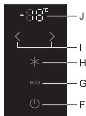
**Eco** funkciju uključite pritiskom tipke **G**. Uređaj tada djeluje na najoptimalniji mogući način.
