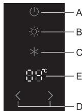
**Uključenje uređaja:** Uređaj uključite kratkim pritiskom tipke **A**.
