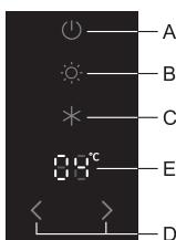
**VitaLED:** pritiskom na tipku **B** uključite/ isključite VitaLED. Prilikom uključenja tipka **B** svijetli. Kad je funkcija aktivirana, uključena je narančasta LED rasvjeta posude za voće i povrće.
