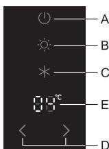
U slučaju previše povećane temperature u uređaju, uključi se zvučni alarm (**isprekidan zvuk**) i bljeska prikaz temperature.
