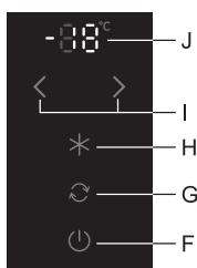
**Isključenje uređaja:** Uređaj isključite dužim pritiskom (3 sekunde) tipke **F** (pažnja: uređaj je još uvijek pod električnim naponom).
